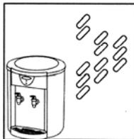
2. Убедитесь, что вода течет из горячего крана, открыв кран горячей воды. Только после этого вставляйте вилку в розетку и включайте нагрев.
